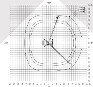
Possibilité de travail en stabilisation réduite à droite, à gauche ou complètement, largeur au sol 2,5 mètres, le travail est limité à l'axe du camion.
